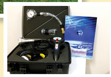
O aparelho chamado Geofone, que identifica vazamentos de água no prédio
