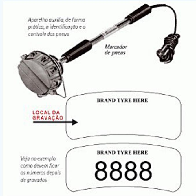
**Figura 22 – Pneu marcado à fogo**
